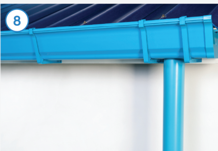
8. หลังจากติดตั้งเสร็จ ควรทดสอบการระบายน้ำ พร้อมทั้งเช็คทำความสะอาดด้วยน้ำบูหรือน้ำยาล้างจาน Tips: กรณีต้องการติดตั้งปลั๊กก่อนบนผนังคอนกรีต เพื่อยึดท่อระบายน้ำฝนเข้ากับผนังบ้าน แนะนำให้ฝังพุกพลาสติกก่อน โดยติดตั้งปลั๊กตัวแรกห่างจากช่อง 10 ซม. และติดตั้งปลั๊กตัวต่อไปให้ระยะห่างกันไม่เกิน 1 ม.
